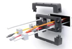
Sistema modular de entrada de cables rápido, seguro y versátil que proporciona sellados seguros y alivio de tensión para cables preensamblados y sin ensamblar con o sin conectores. Fabricado de plástico resistente reforzado con fibra de vidrio. El sistema viene preparado con incrustaciones para colocar pasacables pequeños.
