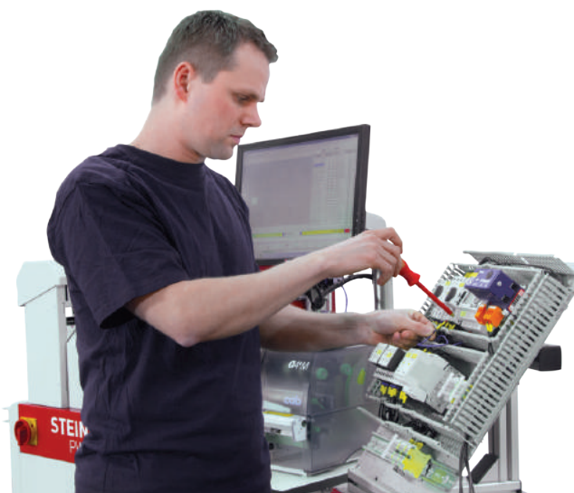
El PWA 5000 se utiliza para el cableado de placas de montaje. Mientras el técnico de cableado monta un conductor, el PWA ya produce el siguiente conductor.
