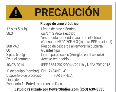
Figura 1. Ejemplo de etiqueta de advertencia de arco eléctrico
