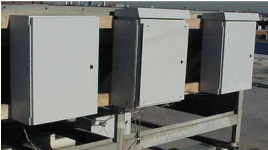
Fotografía de la configuración de la prueba. Los gabinetes utilizados fueron HOFFMAN ComLine modelo E-CL605020 (600mm HX500mm W x 200mm D). El color y acabado de éstos es RAL 7035 (Gris claro texturizado). El protector solar superior es modelo E-SSH5020.
