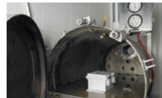
Prueba para Tipo 6, 6P Inmersión en agua
