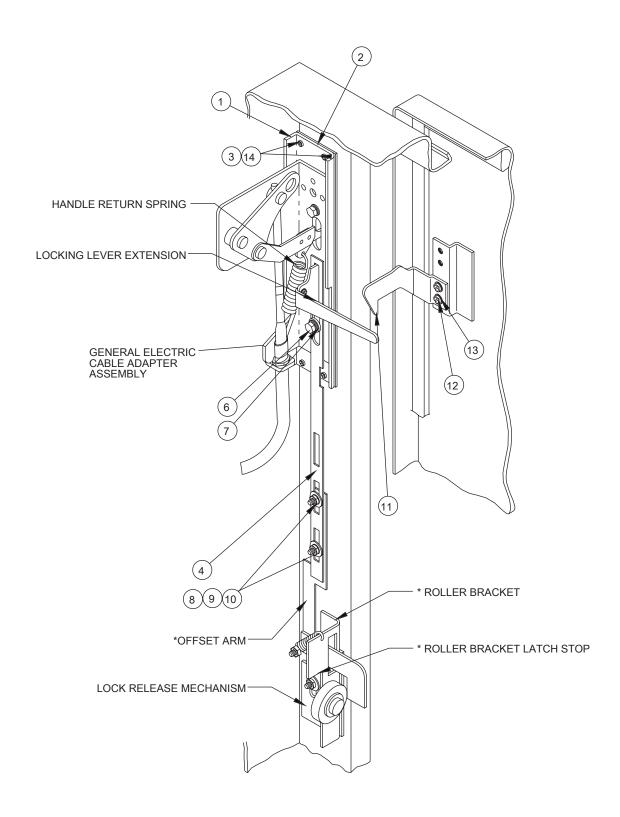
\* PARTS OF RELEASE MECHANISM ON ENCLOSURE WITH DISCONNECT ON RIGHT FLANGE
