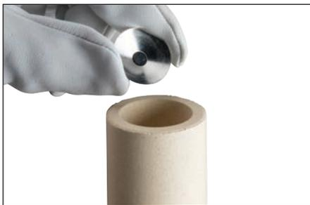
**Fig. 8** – Posizionare il disco di acciaio in Cadweld One Shot con il lato concavo rivolto verso l'alto.
