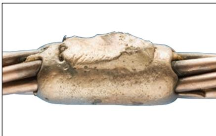
**Fig. 29** – Connessione Cadweld completata.
