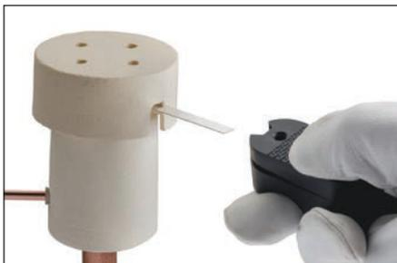
**Fig. 12** – Posizionare la striscia di accensione nel connettore dell'unità di controllo. Rimuovere o proteggere i materiali a rischio di incendio presenti nelle immediate vicinanze della connessione. Segnalare le operazioni di saldatura in corso nell'area al personale presente nelle vicinanze.
