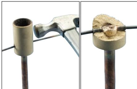
**Fig. 16** – Staccare lo stampo in ceramica Cadweld One Shot dalla connessione. Evitare il contatto con materiali caldi. Per verificare se è stata effettuata una connessione di qualità, consultare la sezione "Standard di qualità nVent ERICO Cadweld".
