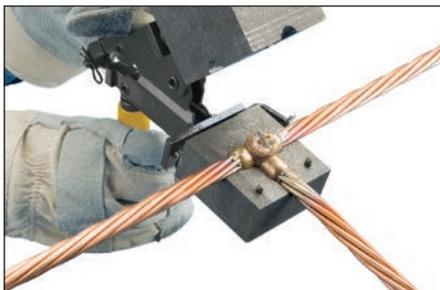
**Fig. 22** – Aprire lo stampo e rimuovere la connessione. Fare attenzione a non scalfire lo stampo. Evitare il contatto con materiali caldi. Per verificare se è stata effettuata una connessione di qualità, consultare la sezione "Standard di qualità nVent ERICO Cadweld".
