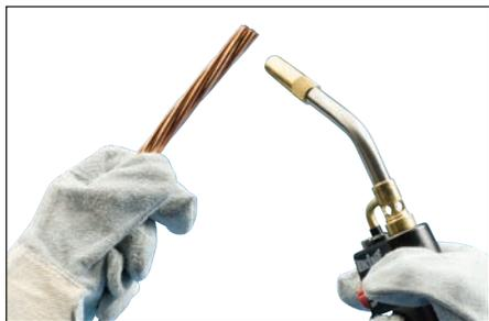
**Fig. 11** – Prima di effettuare la connessione, i conduttori devono essere puliti e asciutti. Prima di effettuare la connessione Cadweld, utilizzare un cannello a propano per asciugare i conduttori metallici e rimuovere eventuali residui di pulizia, solvente o acqua.
