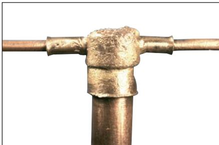
**Fig. 17** – Ora è possibile fare un'altra connessione Cadweld One Shot.
