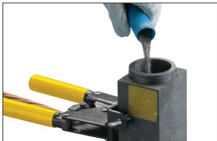
**Fig. 21** – Versare la polvere del materiale per saldatura fuso nello stampo Cadweld Exolon.
