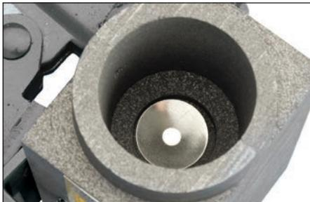
**Fig. 19** – Verificare che il disco di acciaio sia inserito correttamente nel suo alloggiamento.
