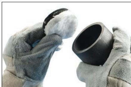
**Fig. 14** – Ogni confezione di Exolon contiene 2 filtri per una connessione a basse emissioni. Inserire i filtri bianchi in ceramica e nero in grafite nel coperchio dello stampo (i filtri devono essere sostituiti ogni 4 connessioni.)
