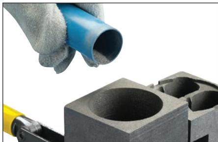
**Fig. 22** – Versare da 1/4 a 1/3 del materiale iniziale sul materiale per saldatura presente nel crogiolo dello stampo.
