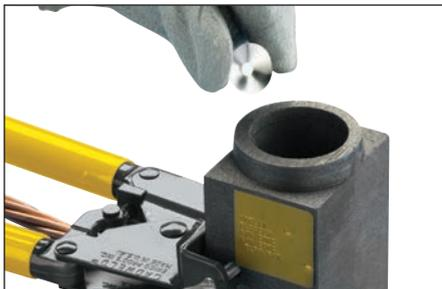
**Fig. 18** – Inserire il disco di acciaio nello stampo con il lato concavo rivolto verso l'alto. Tenere il disco di acciaio sul lato dello stampo e lasciarlo scivolare in posizione.
