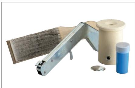
**Fig. 2** – Procurarsi i materiali e le attrezzature corretti per il tipo di connessione che si desidera realizzare. Il sistema Cadweld One Shot richiede uno stampo in ceramica Cadweld One Shot, materiale per saldatura, una spazzola metallica per la pulizia/preparazione dei conduttori, un accenditore a pietra e una torcia a propano.
