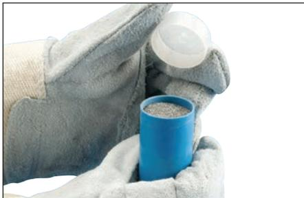
**Fig. 20** – Fatto ciò, prendere il tubo di materiale per saldatura compreso nella confezione di Cadweld Exolon e rimuovere il coperchio sul crogiolo dello stampo.
