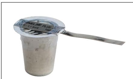
**Fig. 8** – Verificare che la coppa sia ben sigillata e che la striscia di accensione sia fissata saldamente alla guarnizione.
