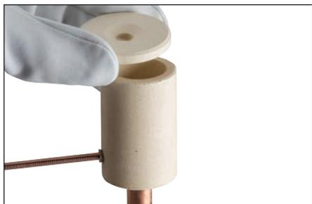
**Fig. 12** – Posizionare il coperchio sulla parte superiore di Cadweld One Shot.
