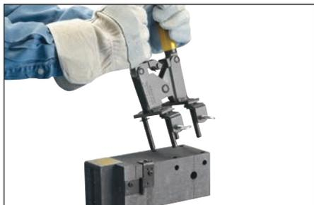
**Fig. 6** – Far scorrere la pinza di bloccaggio nei fori preforati con l'orientamento corretto per le viti a testa zigrinata.
