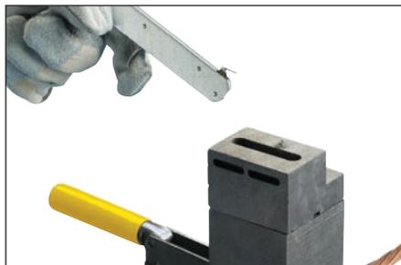
**Fig. 24** – Puntando l'accenditore a pietraina dal lato, accendere il materiale d'innesco sul coperchio dello stampo. Ritirare rapidamente l'accenditore per evitare l'accumulo di incrostazioni.
