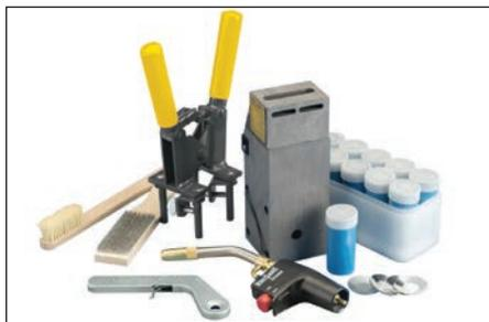
**Fig. 2** – Procurarsi i materiali e le attrezzature corrette per il tipo di connessione che si desidera realizzare. Il tipico sistema Cadweld richiede uno stampo in grafite, una pinza di bloccaggio, materiale per saldatura, una spazzola con setole naturali per pulire lo stampo, una spazzola metallica per pulire/preparare i conduttori, un accenditore a pietra e un cannello a propano.
