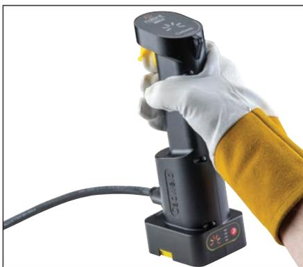
**Fig. 13** – Dall'unità di controllo, sollevare la protezione dell'interruttore a grilletto quindi premere il pulsante di accensione e tenerlo premuto. Le 6 spie poste sulla parte superiore dell'unità si accendono mentre l'unità è in carica. Una volta accesa la sesta luce, l'unità invia una carica alla striscia di accensione, iniziando la reazione esotermica Cadweld Plus.
