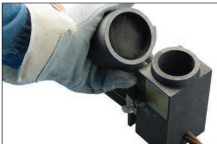
**Fig. 27** – Rimuovere le clip a coccodrillo dal chiodo dell'accenditore. Rimuovere il coperchio in grafite dello stampo Cadweld Exolon.
