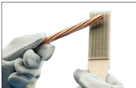
**Fig. 12** – Fatto ciò, utilizzare una spazzola metallica per preparare ulteriormente la superficie dei conduttori (spazzola nVent ERICO T-313 o T-314). Raschiare la superficie esterna per rimuovere sporco e ossidazione. Questa operazione può causare un leggero cambiamento di colore.
