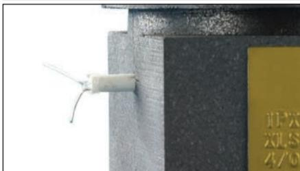
**Fig. 23** – Fatto ciò, prendere un pin dell’accenditore e inserirlo a metà nel piccolo foro sul lato dello stampo, con il lato ad anello rivolto verso il foro. Separare le estremità del cavo.
