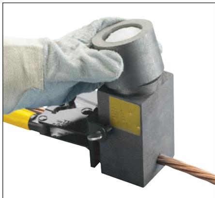
**Fig. 22** – Posizionare il coperchio Cadweld Exolon in grafite sullo stampo con il lato di dimensioni maggiori rivolto verso il basso.
