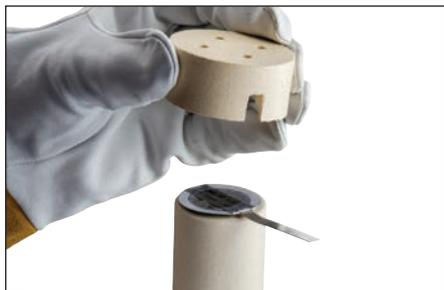
**Fig. 10** – Posizionare il coperchio in ceramica sullo stampo.
