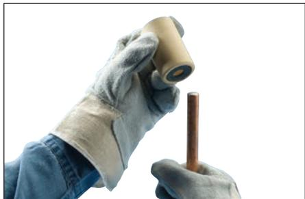
**Fig. 6** – Ogni Cadweld One Shot contiene una guarnizione in gomma sul fondo dello stampo.
