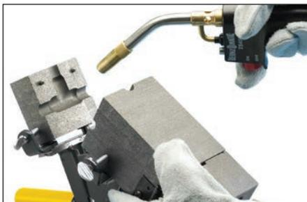
**Fig. 10** – La grafite assorbe l'umidità. Accendere il cannello a propano e asciugare accuratamente entrambi i lati all'interno dello stampo riscaldandoli a circa 120 °C (250 °F).
