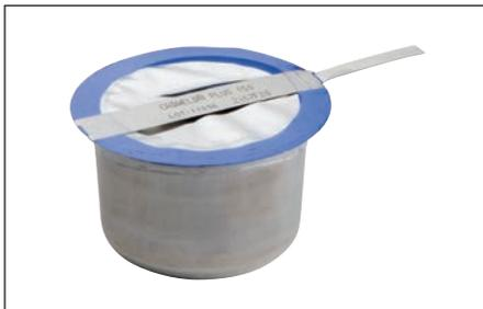
**Fig. 15** – Rimuovere la coppa di materiale per saldatura Cadweld Plus appropriata dal contenitore di plastica. Verificare che la coppa sia ben sigillata e che la striscia di accensione sia fissata saldamente alla guarnizione.
