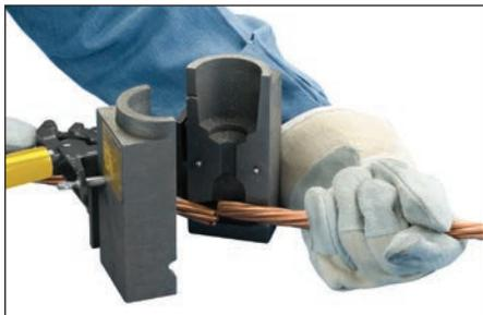
**Fig. 15** – Inserire i conduttori e posizionarli per la connessione.
