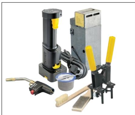
**Fig. 2** – Preparare i materiali e le attrezzature corrette per il tipo di connessione che si desidera realizzare. Il sistema Cadweld Plus richiede uno stampo in grafite, un morsetto per stampo, una coppa di materiale per saldatura Cadweld Plus, una spazzola con setole naturali per la pulizia dello stampo, una spazzola metallica per la pulizia/preparazione dei conduttori, un'unità di controllo e una torcia a propano.
