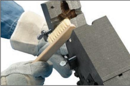
**Fig. 24** – Gli stampi in grafite Cadweld hanno una durata di circa 50 connessioni. Utilizzare un panno di cotone morbido o una spazzola a setole morbide (nVent ERICO articolo T394) per pulire l'interno della cavità dello stampo e del coperchio.
