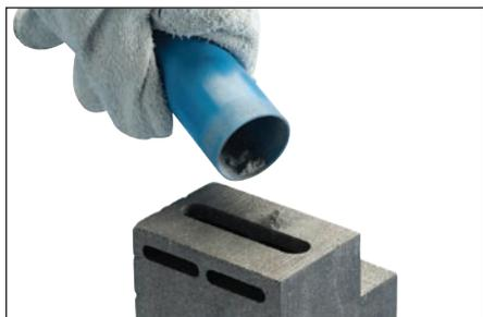
**Fig. 23** – Chiudere il coperchio e versare i restanti 3/4 a 2/3 del materiale per l'innesco nella scanalatura presente sul coperchio dello stampo.
