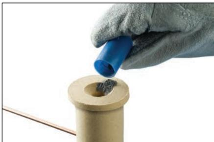
**Fig. 14** – Versare il materiale iniziale/d'innesco sul coperchio di Cadweld One Shot.
