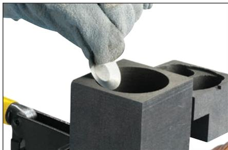
**Fig. 16** – Inserire il disco di acciaio nello stampo con il lato concavo rivolto verso l'alto. Tenere il disco di acciaio sul lato dello stampo e lasciarlo scivolare in posizione.
