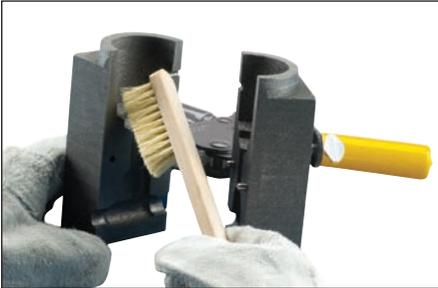
**Fig. 30** – Gli stampi in grafite Cadweld Exolon hanno una durata di circa 50 connessioni. Utilizzare un panno di cotone morbido o una spazzola a setole morbide (nVent ERICO articolo T394) per pulire l'interno della cavità dello stampo e del coperchio; rimuovere eventuali scorie lasciate dalla reazione esotermica.
