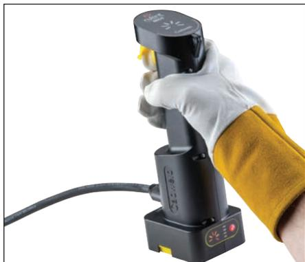
**Fig. 20** – Dall'unità di controllo, sollevare la protezione dell'interruttore a grilletto quindi premere il pulsante di accensione e tenerlo premuto. Le 6 spie poste sulla parte superiore dell'unità si accendono mentre l'unità è in fase di ricarica. Una volta accesa la sesta luce, l'unità invia una carica alla striscia di accensione, iniziando la reazione esotermica Cadweld Plus.
