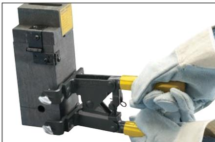
**Fig. 8** – Chiudere le impugnature per bloccare saldamente lo stampo. Verificare che lo stampo presenti una tenuta adeguata.
