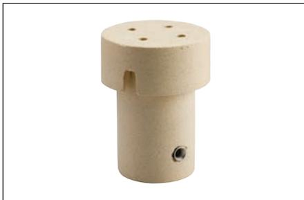
**Fig. 3** – Verificare che lo stampo in ceramica non sia usurato o rotto, poiché durante la reazione ciò può causare fuoriuscite di metallo di saldatura fuso.
