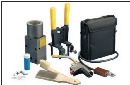
**Fig. 2** – Preparare i materiali e le attrezzature corretti per il tipo di connessione che si desidera realizzare. Il sistema Cadweld Exolon richiede uno stampo in grafite Cadweld Exolon, una pinza di bloccaggio, materiale per saldatura, una spazzola metallica per la pulizia/preparazione di conduttori, un gruppo batterie e una torcia a propano.
