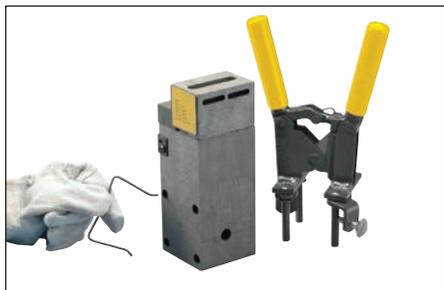
**Fig. 5** – Prima dell'uso, rimuovere la piccola staffa metallica utilizzata per tenere temporaneamente insieme lo stampo. Mettere da parte la staffa.
