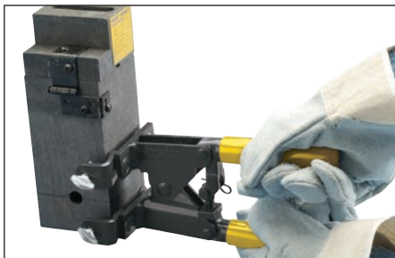
Fig. 8 – Fermer les poignées pour verrouiller fermement le moule. Vérifier que le moule est muni du joint approprié.
