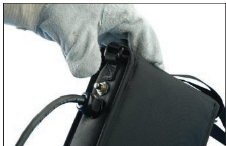
Fig. 26 – À l'aide du bloc-batterie Cadweld Exolon, appuyer sur le bouton. À ce moment-là, l'unité enverra une charge à la goupille d'allumage. La goupille d'allumage déclenche la réaction exothermique Cadweld Exolon.
