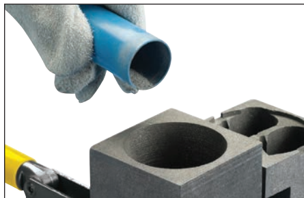
Fig. 22 – Verser de \frac{1}{4} à \frac{1}{3} du matériau de démarrage sur le métal d'apport dans le creuset du moule.
