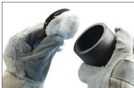
Fig. 14 – Chaque boîtier Exolon contient 2 filtres pour une connexion à faible émission. Insérer les filtres en céramique blanche et graphite noir dans le couvercle du moule. (Les filtres doivent être changés toutes les 4 connexions.)
