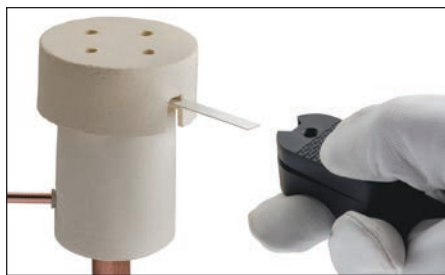
Fig. 12 – Placer la bande d'allumage dans le connecteur du boîtier de commande. Retirer ou protéger des risques d'incendie à proximité immédiate du raccordement. Informer le personnel à proximité des opérations de soudage dans la zone.
