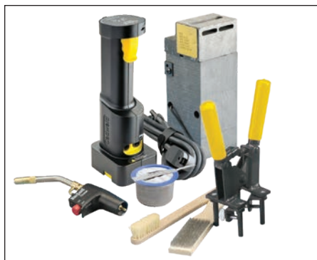
Fig. 2 – Préparez les matériaux et l'équipement appropriés pour le type de connexion que vous effectuez. Le système Cadweld Plus nécessite un moule en graphite, un étrier de moule, un métal d'apport Cadweld Plus, une brosse à poils naturels pour le nettoyage des moules, une brosse métallique pour le nettoyage/la préparation des conducteurs, un boîtier de commande et une torche au propane.
