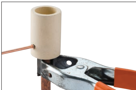
Fig. 7 – Insérez les conducteurs et positionnez-les pour la connexion.
