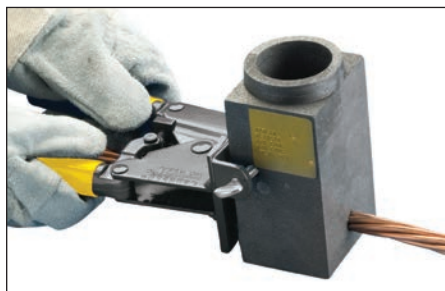
Fig. 16 – Fermer hermétiquement l'attache une fois que les conducteurs sont correctement positionnés.
