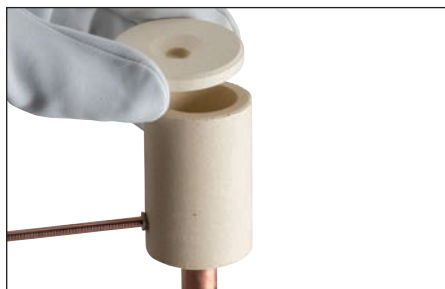
Fig. 12 – Placez le couvercle sur le dessus du Cadweld One Shot.
