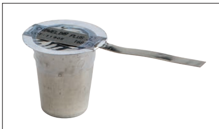
Fig. 8 – Inspecter la coupelle pour s'assurer qu'elle est hermétiquement scellée et que la bande d'allumage est solidement fixée au joint.
