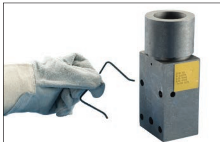
Fig. 5 – Retirer le petit support métallique qui est utilisé pour maintenir temporairement le moule ensemble avant de l'utiliser. Mettre le support de côté.
