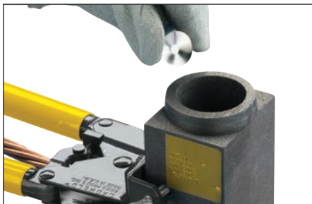
Fig. 18 – Insérez le disque en acier (côté concave vers le haut) dans le moule. Maintenez le disque en acier sur le côté du moule et laissez-le glisser en place.
