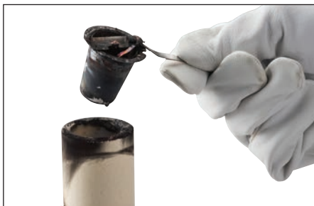
Fig. 14 – Retirez et jetez la coupelle métallique soudée Cadweld Plus usagée.
