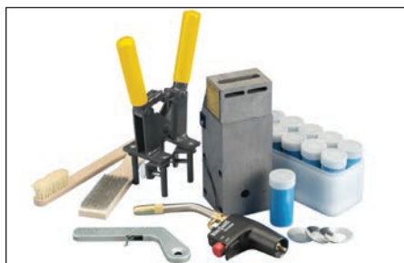
Fig. 2 – Rassemblez les matériaux et l'équipement appropriés pour le type de connexion que vous effectuez. Le système Cadweld typique nécessite un moule en graphite, une pince à attache, un métal d'apport, une brosse à poils naturels pour le nettoyage des moules, une brosse métallique pour le nettoyage/la préparation des conducteurs, un allumeur à flint et une torche au propane.
