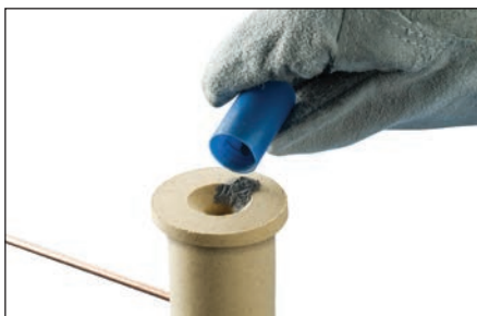
Fig. 14 – Versez le matériau de démarrage sur le couvercle Cadweld One Shot.
