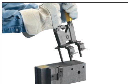
Fig. 6 – Faire glisser l'attache de la poignée dans les trous pré-perçés avec l'orientation appropriée pour les vis à oreilles.
