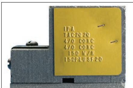
Fig. 4 – Inspectez l'étiquette d'identification du moule pour vous assurer qu'elle correspond à l'application, indiquée par :
