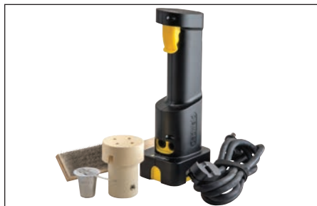
Fig. 2 – Préparez les matériaux et l'équipement appropriés pour le type de connexion que vous effectuez. Le système Cadweld Plus One Shot nécessite un moule en céramique Cadweld One Shot, un métal d'apport Cadweld Plus, une brosse métallique pour le nettoyage/la préparation des conducteurs, un boîtier de commande de soudage exothermique nVent ERICO Cadweld Plus Impulse et un chalumeau au propane.
