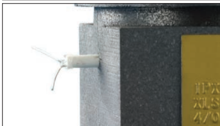
Fig. 23 – Ensuite, prendre une goupille d'allumage et la placer à mi-chemin dans le petit trou sur le côté du moule, avec le côté boucle orienté vers l'intérieur du trou. Étendre les fils conducteurs.
