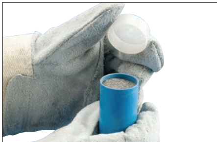
Fig. 19 – Retirez le couvercle sur le creuset du moule.
