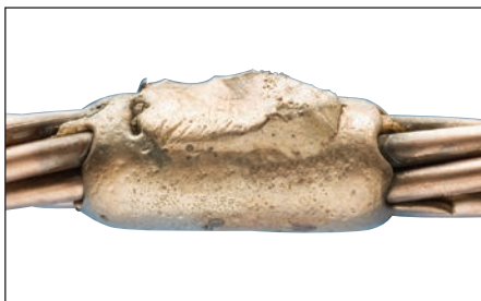
Fig. 29 – Connexion Cadweld terminée.
