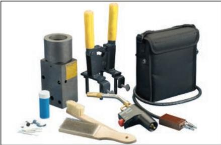
**图 2** - 为正在进行的连接类型准备合适的材料和设备。Cadweld Exolon 系统需要 Cadweld Exolon 石墨模具、手柄夹具、焊药、用于清洁/制备导体的钢丝刷、电池组和丙烷喷灯。
