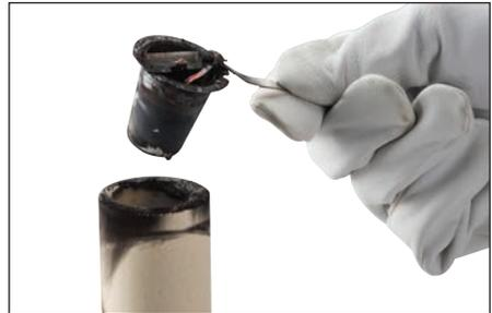
图 14 - 拆下并处置用过的 Cadweld Plus 焊接金属杯。
