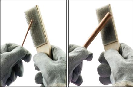
**图 5** - 接下来, 用钢丝刷进一步处理导体表面和接地棒 (Cadweld T313 或 T314 钢刷)。刮擦外表面, 以清除污垢和氧化层。您会发现颜色稍有变化。
