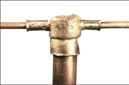
**图 17** - 您可以进行另一个 Cadweld 一次性套件联接。
