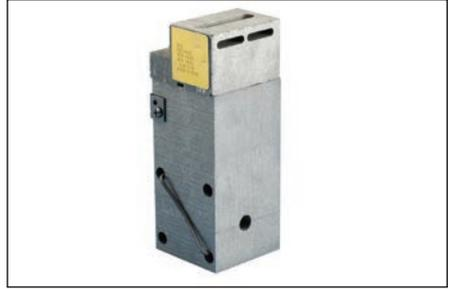
**图 3** - 检查并确保石墨模具不存在可能导致熔焊反应过程中泄漏的磨损或断裂。
