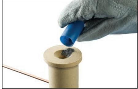
图 14 - 将引燃药倒入 Cadweld 一次性套件盖中。
