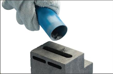
**图 23** - 盖上盖子，将剩余的 3/4 至 2/3 引燃药倒入模具盖上的槽中。
