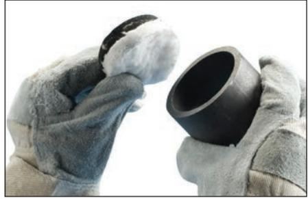
**图 14** - 每个 Exolon 材料包内含 2 个用于低排放联接的过滤器。将白色陶瓷和黑色石墨过滤器插入模具盖。（过滤器必须每 4 次联接后更换一次。）
