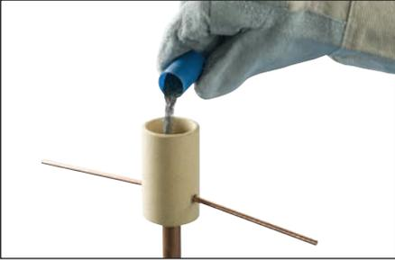
图 11 - 将松散焊药粉末倒入 Cadweld 一次性套件模具中。
