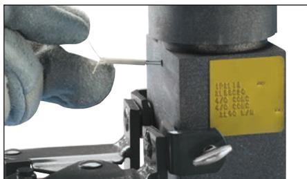
图 23 - 接下来, 取下一个点火器销, 将其一半放于模具侧面的小孔中, 环面朝孔中。展开引线。
