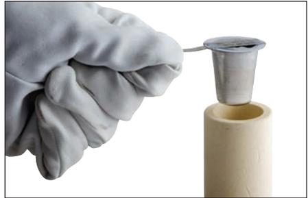
**图 9** - 将焊药杯放入模具顶部。确保起燃条嵌套在顶部边缘的凹槽中。
