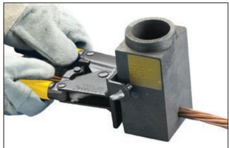
**图 16** - 一旦导体定位正确，请紧闭夹具。
