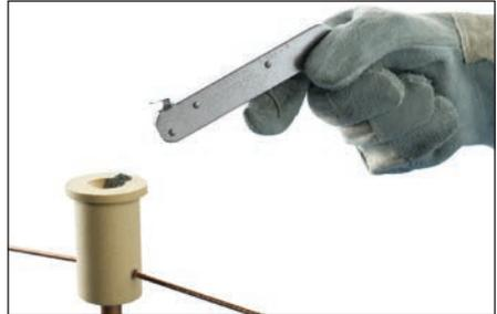
图 15 - 使用点火器从侧面瞄准，点燃模具盖上的引燃药。迅速撤回点火器，以防止结垢。
