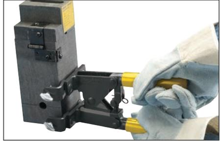
**图 8** - 合上手柄将模具锁紧。检查模具的密封性是否合适。
