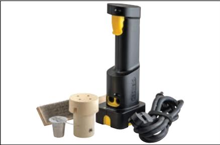
**图 2** – 准备适合联接类型的材料和设备。Cadweld Plus 一次性套件系统需要 Cadweld 一次性套件陶瓷模具、Cadweld Plus 焊药、用于清洁/制备导体的钢丝刷、盈凡艾力高nVent ERICO Cadweld Plus 电子式放热焊接控制器和丙烷喷灯。
