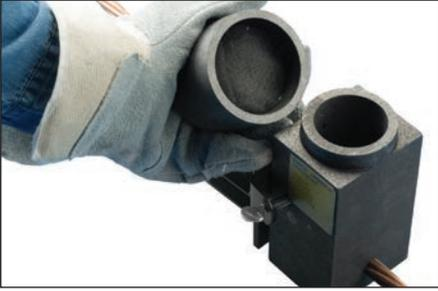
**图 27** - 从点火器销上取下鳄鱼夹。取下 Cadweld Exolon 模具的石墨盖。
