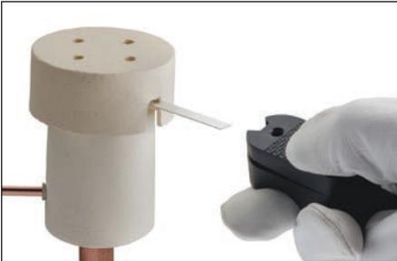
图 12 - 将起燃条放入电子控制器接头中。清除联接处附近的火灾隐患或采取保护措施。告知附近人员该区域正在进行焊接作业。
