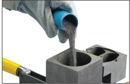
图 20 - 将松散焊药粉末快速倒入模具中。
