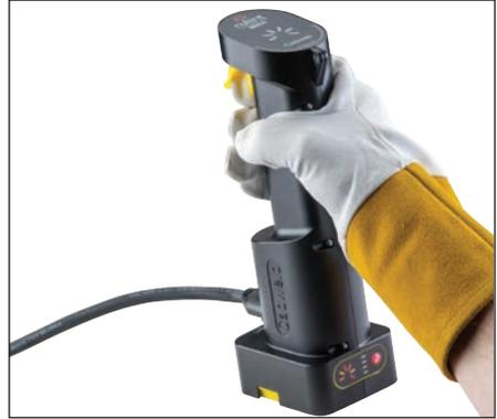
图 13 - 使用控制器，抬起触发器盖，然后按下点火按钮并按住。设备充电时，可以看到装置顶部的 6 个灯亮起。第 6 个灯点亮后，装置将向起燃条发送电荷，启动 Cadweld Plus 放热反应。
