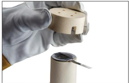
**图 10** - 将陶瓷盖放在模具上。
