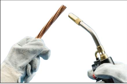
**图 11** - 在完成联结前，导体应被清洁干燥。在进行 Cadweld 联结前，使用丙烷喷灯干燥线缆，清除残留的清洁残留物、溶剂或水。
