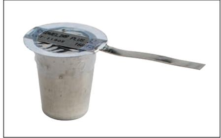
**图 8** - 检查焊药杯, 确保其密封牢固, 且起燃条牢固固定在焊药杯上。
