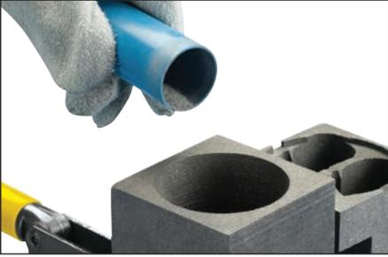
**图 22** - 将 1/4 至 1/3 的引燃药倒入模具坩埚中的焊药上。
