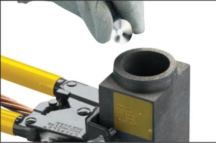
图 18 - 将垫片（凹面朝上）插入模具。握住垫片并沿着模具边沿，让其滑入到位。
