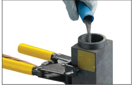
图 21 - 将松散焊药粉末倒入 Cadweld Exolon 模具中。
