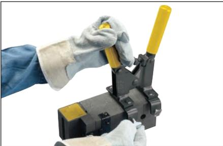
**图 7** - 将夹具指旋螺丝拧紧到模具上。
