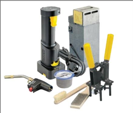
**图 2** - 为正在进行的联接类型准备合适的材料和设备。Cadweld Plus 系统需要石墨模具、模具夹、Cadweld Plus 焊药杯、用于模具清洁的天然毛刷、用于清洁/制备导体的钢丝刷、控制装置和丙烷喷灯。
