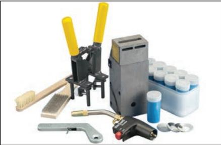
**图 2** - 为正在进行的放热焊接类型收集适当的材料和设备。典型的 Cadweld 系统需要石墨模具、手柄夹、焊药、用于模具清洁的天然毛刷、用于清洁/制备导体的钢丝刷、点火器和丙烷喷灯。
