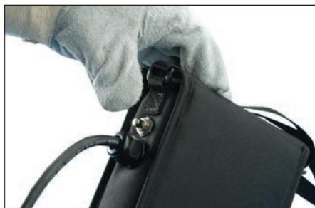
图 26 - 要使用 Cadweld Exolon 电池组, 请按下按钮。此时, 装置将向点火器销发送电荷。点火器销将引发 Cadweld Exolon 放热反应。
