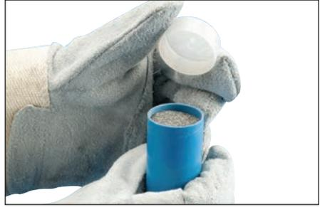
图 19 - 并取下焊药管的盖子。
