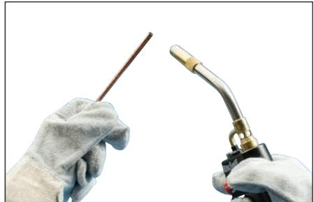
**图 4** - 链接前, 导体应被清洁干燥。在进行 Cadweld 一次性套件链接前, 使用丙烷喷灯干燥电线导体, 清除残留的清洁残留物、溶剂或水。
