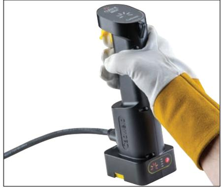
图 20 - 使用电子控制器，抬起触发器盖，然后按下点火按钮并按住。设备充电时，可以看到装置顶部的 6 个灯亮起。第 6 个灯亮起后，装置将向引燃条发送电荷，启动 Cadweld Plus 放热反应。
