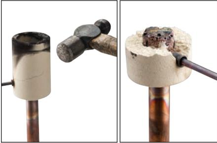
**图 15** - 将陶瓷 Cadweld 一次性套件模具与联接件断开。避免接触热材料。参见“盈凡艾力高 nVent ERICO Cadweld 质量标准”部分，了解是否已实现合格联接。
