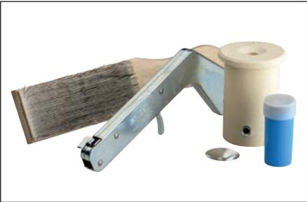
**图 2** - 为正在进行的连接类型准备合适的材料和设备。Cadweld 一次性套件系统需要 Cadweld 一次性套件陶瓷模具、焊药、用于清洁/制备导体的钢丝刷、火石点火器和丙烷喷灯。
