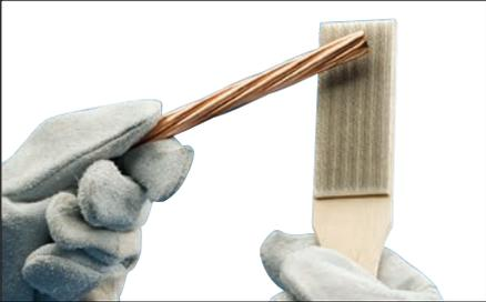
**图 12** - 接下来，用钢丝刷进一步处理导体表面（盈凡艾力高nVent ERICO T313 或 T314 钢刷）。刮擦外表面，以清除污垢和氧化层。您会发现颜色稍有变化。
