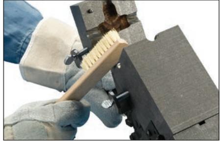
**图 24** - Cadweld 石墨模具可进行约 50 次联接。用软棉布或软毛刷 (盈凡艾力高nVent ERICO 部件号 T394) 清洁模腔和盖的内部。
