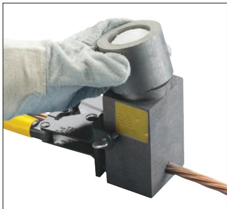
图 22 - 将石墨 Cadweld Exolon 盖放在模具上, 较大面朝下。
