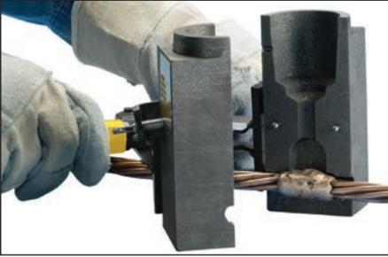
**图 28** - 打开模具并取下联接件。小心防止模具碎裂。避免接触热材料。参见“Cadweld 质量标准”部分, 了解是否已实现合格联接。
