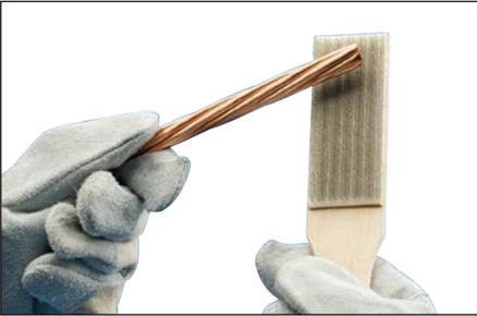
**图 12** - 接下来，用钢丝刷进一步处理导体表面（nVent艾力高 T313 或 T314 钢刷）。刮擦外表面，以清除污垢和氧化层。您会发现颜色稍有变化。
