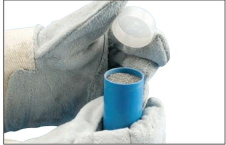
图 20 - 接下来，从 Cadweld Exolon 材料包中取出一管焊药，并取下焊药管的盖子。
