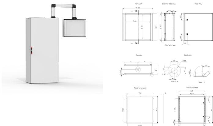
O armário de controlo de interface do operador em aço macio, OICE, tem um padrão de orifícios pré-maquinado para permitir a fixação de um braço articulado e de uma tampa frontal amovível, com um grau de proteção IP 55. Os componentes podem ser facilmente instalados graças à tampa frontal amovível, mas também serão facilmente acessíveis através de uma porta traseira. As pegas laterais no armário permitem a deslocação fácil do armário para a posição de trabalho pretendida.
