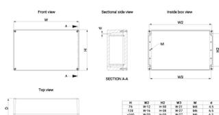
La gamma di cassette di derivazione in poliestere, MGRP, con grado di protezione IP 66, 67, è disponibile sul mercato in molti formati diversi. La gamma MGRP è adatta ad ambienti indoor e outdoor grazie all'elevata resistenza alla corrosione e ai raggi UV. Poiché acqua e polvere non possono penetrare all'interno della cassetta di derivazione, il rischio di guasto dei componenti è eliminato e, con esso, gli inutili tempi di inattività.
