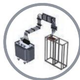
Connessione del sistema Flexbus tra apparecchiatura elettrica e trasformatore
