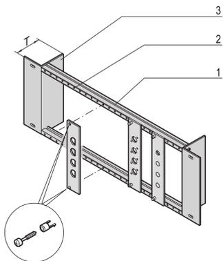
Le support du module est nécessaire pour le montage des faces avant de largeur partielle avec des découpes D-SUB, de type ST 3 ou FDDI, avec ou sans glissière d'arrêt traction.
