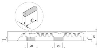
Blocs isolants pour les barres bus afin de protéger les bornes contre les courts-circuits et les dommages accidentels. Les blocs fournissent un support rigide pour séparer physiquement les barres bus du rack de toutes les sources d'énergie électrique et sont conçus pour faciliter le montage de la barre bus.
