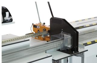
La machine semi-automatisée NC-CUT optimise la coupe des rails DIN et des conduits de câbles pour augmenter la productivité de la main-d'œuvre et minimiser les déchets de coupe. Prenez le contrôle et automatisez le traitement en important vos schémas de montage et de disposition de panneaux dans le logiciel de la machine. Le NC-Cut fournit ensuite une liste simplifiée des découpes et vous guide tout au long du processus de découpe.
