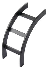
Les sections courbées en forme d'échelle permettent un changement de direction vertical. Elles sont faites d'acier tubulaire de 1 à 1/2 pouces x 3/8 pouces (38 mm x 8 mm), avec une finition peinte ou plaquée. Les traverses sont soudées à l'intérieur (courbes intérieures) ou à l'extérieur (courbes extérieures) de la section. Elles se connectent à une section droite avec des kits de raccordement. Elles sont également conçues pour les câbles catégorie 5e, 6, 6A et de fibre optique.
