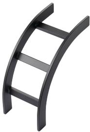
Las secciones curvadas de la escalerilla proporcionan un cambio vertical en la dirección. Están hechas de acero tubular de 1-1/2 pulgadas x 3/8 pulgadas (38 mm x 8 mm) con un acabado pintado o chapado. Los travesaños se sueldan en el interior (doblados interiores) o en el exterior (doblados exteriores) de la sección. Se conectan a la sección recta con kits de conexión de empalmes. También están diseñados para cables de fibra óptica de categoría 5e, 6, 6A.
