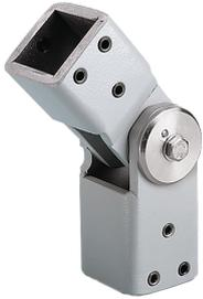
La unión intermedia del sistema 80 Compact Series 4 une dos tubos horizontales juntos para una mayor longitud y crea un pivote. El rango giratorio es de aproximadamente 180 grados.
