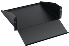
El estante de acero para teclado/monitor tiene un diseño ergonómico y capacidad para un monitor y un teclado. El estante se monta en la brida frontal de un rack de marco abierto, pero puede montarse en un gabinete si los ángulos del rack se ajustan hacia atrás para dejar espacio libre en la puerta. Utiliza 3U de espacio en rack y está disponible en versiones de rack de 19 y 23 pulgadas, con una clasificación de carga de 200 lb (91 kg).
