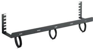
El rack de amarre de marco abierto proporciona gestión de cableado sin ocupar espacio en el rack. Esta unidad se monta horizontalmente en racks de 19 pulg., ocupa el mínimo espacio pero controla y separa de forma eficaz los tendidos de cables. Incluye ranuras para enrollar cables. Cada rack incluye 10 envolturas de VELCRO® para cables de 8 pulg. (203 mm) en negro, con herraje de montaje incluido. Tenga en cuenta que VELCRO es una marca comercial de VELCRO Industries B.V.
