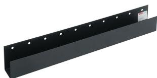
La canaleta para cables horizontal ProLine se utiliza para enrutar el cable de adelante hacia atrás en un servidor o gabinete de datos. Se monta en un lado o en la parte superior de un riel sujetador de 1 o 3 filas. También se puede montar directamente en los canales de montaje con el kit de montaje APSM6CN. Este producto presenta la capacidad de usar varias unidades juntas.
