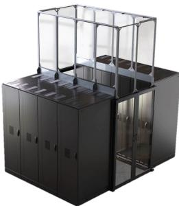
Funciona con un grupo de gabinetes que rodean un pasillo caliente. Está soportado en la parte superior de los gabinetes y canaliza el aire caliente que escapa del equipo de servidores alojados dentro de los gabinetes hacia el plénum en el techo. Esto se usa para separar completamente el aire frío del aire caliente, lo que reduce drásticamente los costos de energía del centro de datos.
