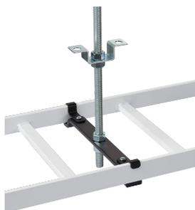
El kit de soporte central de pasacables es una varilla roscada y un soporte que sostiene el centro de la escalerilla desde un techo. El kit incluye un travesaño para escalerilla de alta resistencia, dos soportes de montaje, dos tornillos N.º 12-24, una varilla roscada de 5/8 pulg., una manga protectora y cuatro tuercas de 5/8 pulg. Los soportes deben utilizarse al menos cada 5 pies (1.5 m).
