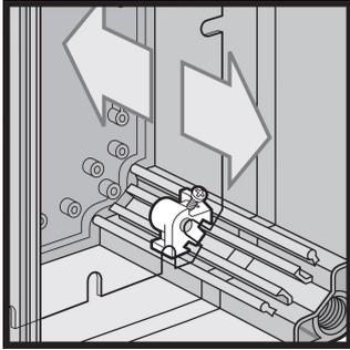
Los accesorios de profundidad del panel QLine I se fijan a los rieles moldeados en las esquinas del gabinete para facilitar el ajuste de rango completo del panel de adelante hacia atrás. El paquete incluye cuatro accesorios de poliamida y tornillos chapados. Úselo en todos los gabinetes QLine I.
