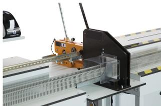
La máquina semiautomática NC-CUT optimiza el corte de ductos para cableado y rieles DIN para aumentar la productividad de la mano de obra y minimizar los residuos de corte. Tome el control y aproveche la automatización importando al software de la máquina sus planos de disposición de paneles de montaje ya creados; NC-Cut proporciona una lista de cortes simplificada y le guía a través de los cortes con facilidad.
