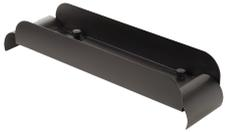
La parte superior de cascada con marco abierto se usa para tender el cable a través de la parte superior de un rack de marco abierto. Proporciona un radio de doblez de transición horizontal a vertical para la instalación de cables de fibra óptica y de categoría 5, 6, 6A. También es un sistema completo de gestión de cableado cuando se usan organizadores de cables verticales y horizontales. La parte superior de cascada se monta en racks de marco abierto de 2 y 4 postes.
