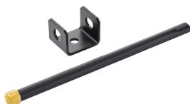
El kit de postes retenedores de la guía de cables proporciona capacidad adicional para la escalerilla. El poste retenedor se monta en el larguero lateral del rack. El poste está hecho de un tubo de 1/2 pulg. sin rosca. El kit incluye tapa de poste y herraje de montaje.
