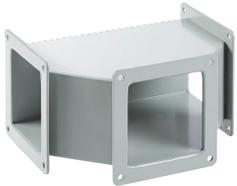
Las conexiones "T" de paso de acero inoxidable se usan para hacer giros tipo T en recorridos del ducto. Se conecta a otras secciones del ducto y protege alambres y cables contra el polvo, en una amplia gama de aplicaciones industriales.
