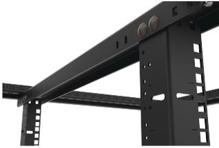
Los ángulos de rack se venden en pares con la marca RU en todos los lados. Un lado está roscado 10-32 mientras que el otro lado tiene un orificio cuadrado (0.375 x 0.375 pulgadas). Ambos lados están espaciados según el estándar universal EIA. Los ángulos de rack se pueden ensamblar en configuración de orificio roscado o cuadrado. Los ángulos para rack y los soportes de montaje están hechos de acero de gran calibre. Se incluyen todos los herrajes y soportes para ensamblarlos en el gabinete.
