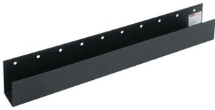
La canaleta para cables horizontal ProLine se utiliza para enrutar el cable de adelante hacia atrás en un servidor o gabinete de datos. Se monta en un lado o en la parte superior de un riel sujetador de 1 o 3 filas. También se puede montar directamente en los canales de montaje con el kit de montaje APSM6CN. Este producto presenta la capacidad de usar varias unidades juntas.
