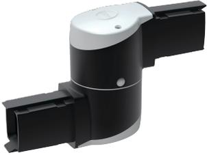
Unión intermedia Syspend 281-Max, para unir dos tubos horizontales y obtener un recorrido más largo. El brazo tiene una capacidad de rotación o giro de 300 grados. Incluye tope de seguridad y rodamiento libre de mantenimiento. El uso de la unión intermedia reduce la capacidad de carga del sistema a 179 lb (81.2 kg) a 3.3 pies (1 m).
