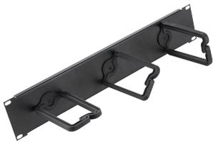
El conjunto de anillo en D de marco abierto se monta horizontalmente en racks de 19 pulg. Se encarga de enrutar, dirigir y agrupar los paquetes de cables verticales. Los anillos en D giran en el soporte para facilitar la colocación del cable; se abren a presión para facilitar el acceso a las actualizaciones del cable, a la vez que proporcionan la capacidad de un cierre seguro. Los anillos en D están hechos de plástico negro. Se incluye todos los herrajes de montaje necesarios.
