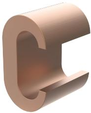
Las derivaciones en C para trabajo pesado empalman dos conectores trenzados o sólidos. Con respecto a que la herramienta es para trabajo pesado, se requiere una herramienta de engarce (no incluida) para apretar correctamente las derivaciones en C alrededor de los conectores.
