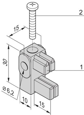
Montagewinkel für Sammelschienen oder Sammelschienenmodule sind vom Lastkreis getrennte Montageeinheiten für Erdungsschienen. Adapter mit zugewiesenen Nennströmen können vorhanden sein, die den Verbraucherabgangsleitungen den Arbeitsstrom über Kabelverbindungen zuführen.
