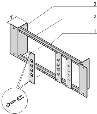
Für den Ausbau mit Teilfrontplatten mit SUB-D, ST Typ 3 oder FDDI-Ausbrüchen ist ein Modulträger erforderlich. Mit oder ohne Zugentlastungsschiene.
