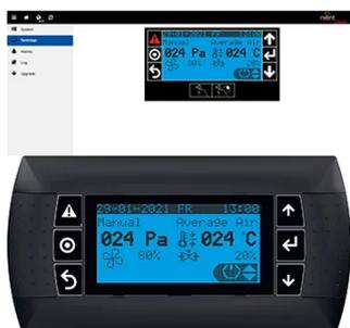
Die Display-Einheit ermöglicht die lokale Konfiguration, Inbetriebnahme und Überwachung der RackChiller Rear Door. Sie verfügt über ein LCD-Display und 6 Funktionstasten. Sie wird direkt an der Außenverkleidung des Kühlers installiert und an die vorverdrahtete Verkabelung innerhalb der Einheit angeschlossen.
