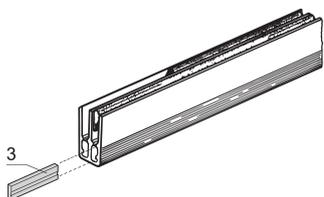
Isolieranschlage fur Sammelschienen zum Schutz der Klemmen vor versehentlichen Kurzschlussen und Beschadigung. Die Anschlage bieten eine starre Verbindung zur physischen Trennung der Schrank sammelschienen von allen Stromquellen und sind fur einfache Befestigung der Sammelschiene ausgelegt.
