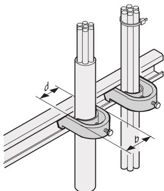
C-Schienen dienen dem besseren Kabelmanagement. Die Installation erfolgt in der Regel hinter den 19-Zoll-Holmen. Sie sind kompatibel mit Standard-Kabelschellen.
