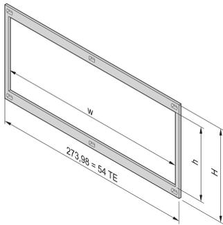
Bei der Installation des Frontrahmens wird der Kontakt zwischen Baugruppenträgern und Baugruppen hergestellt. Sie muss verwendet werden, wenn ein Kunde ein Kit zur horizontalen Leiterplattenmontage ausgewählt hat.
