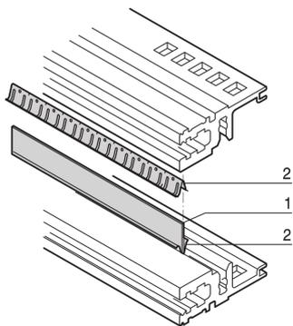
Der Kontaktstreifen dient der Kontaktierung der Modulschienen. Wenn zwei Modulschienen übereinander montiert werden, bildet ein Metallstreifen und eine Dichtung die EMV-Schirmung.
