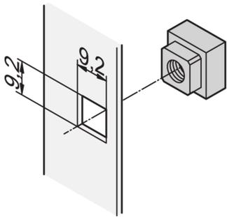
Vierkantmuttern haben eine höhere Kontaktfläche und werden im Gegensatz zu Sechskantmuttern nicht abgerundet. Für präzise, verdrehsichere und spielfreie Montage bitte Vierkantmuttern verwenden.
