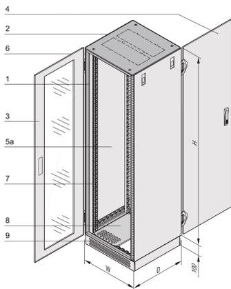
Basisschrank für Verkabelung und Netzwerkgeräte. Kühlung über Konvektion oder Lüfter im Dach.
