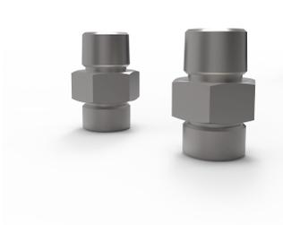
Bei diesem Sanitäranschlussadapter handelt es sich um ein Außengewinde mit einem 1-Zoll-BSPP-Flachdichtungsgewinde an einem Ende und einem 1-Zoll-NPT am anderen Ende. Mit diesem Adapter können die 1-Zoll-Schläuche in BSP-Ausführung für die Installation in NPT-Kühlwasseranlagen in US-Ausführung angepasst werden.
